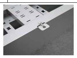
天板と中央梁中間部はビス穴を合わせて、キャップスクリューM6×12のビスで固定します。
